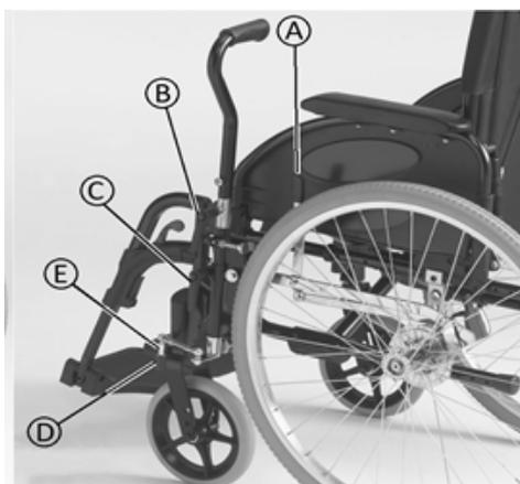
O operador agarra na alavanca de propulsão que impulsiona a cadeira de rodas para a frente ou para trás (alavanca de marcha-atrás (A), a posição central é o ponto-morto) graças um movimento para dentro e para fora; a orientação é realizada simplesmente rodando a alavanca de propulsão para o lado esquerdo/direito e a travagem é efetuada puxando a alavanca de propulsão para trás.
